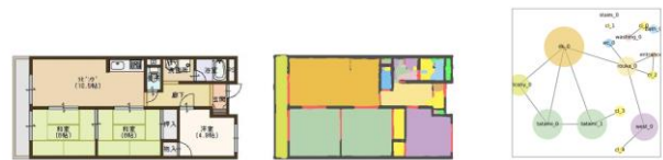
図2 アクセスグラフの誤変換の例
