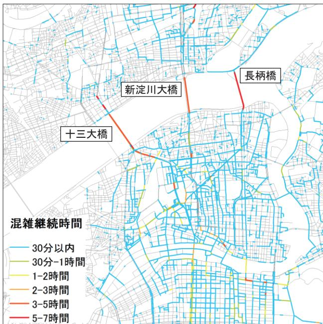
図12 橋梁付近における混雑継続時間（ケース1b）
